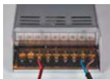
1) Подключить провод DM111 к БП, соблюдая полярность. 2) Подключить питание 220V/50Hz к БП: синий провод нейтраль N, коричневый - фаза L
