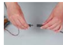
Соединить провод DM111 с разъемом светодиодной ленты
