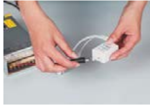
Вставить разъем DM111 в коннектор контроллера
