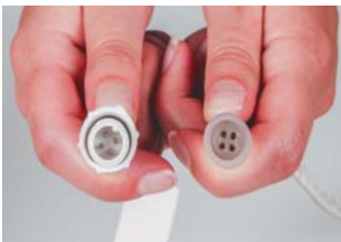
Вставить четырехконтактный коннектор в соответствующий разъем ленты, используя положения «ключа» - выступа на соединителе контроллера и «ключа» - углубления на соединителе ленты.
