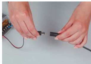
Вставить четырехконтактный коннектор в соответствующий разъем ленты, используя положения «ключа» - выступа на соединителе контроллера и «ключа» - углубления на соединителе ленты.
