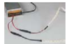
1) Соединить провода DM111 с разъемами от лент 2) На одну линию нельзя подключать более 10 метров одноцветной ленты
