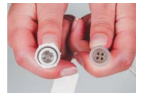
Соединить выход уже подключенной светодиодной ленты с соответствующим входом усилителя; выступ на коннекторе ленты должен совпасть с углублением в коннекторе усилителя.
