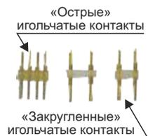
✓ Подключение к блоку питания или контроллеру. Лента подключается к блоку питания (контроллеру) с помощью игольчатого разъема, входящего в комплект блока питания или контроллера. Такой разъем имеет с одной стороны «острые» контакты для подключения ленты, а с другой стороны — «закругленные» контакты для подключения к муфте блока питания или контроллера.
